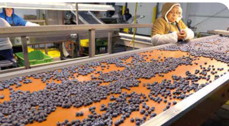
Fot. 11. Sortowanie ręczne następuje po przejściu owoców przez sortownię optyczną
